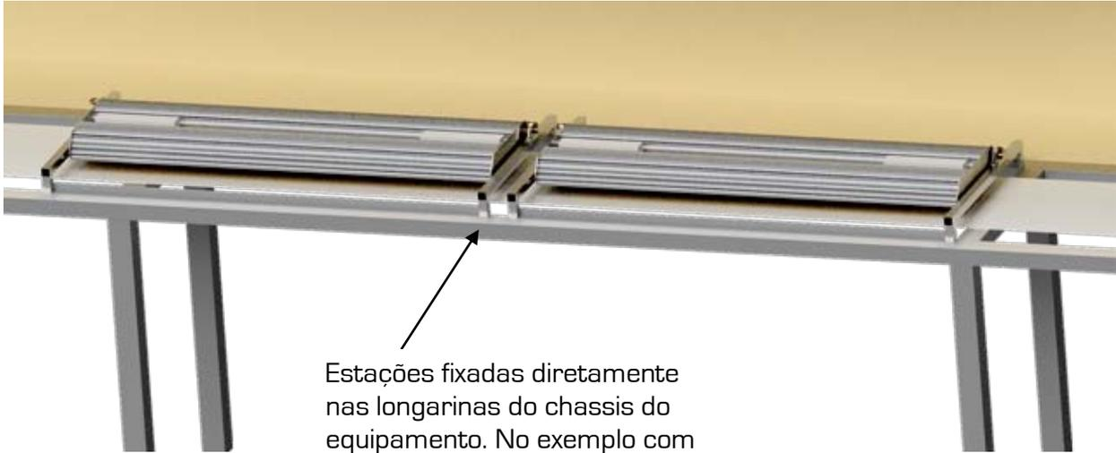
Estações fixadas diretamente nas longarinas do chassis do equipamento. No exemplo com as capotas abertas.
